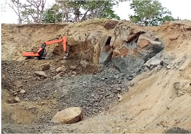
Foto 21. Explotación de material tipo escolleras con maquinaria (Ripper)
